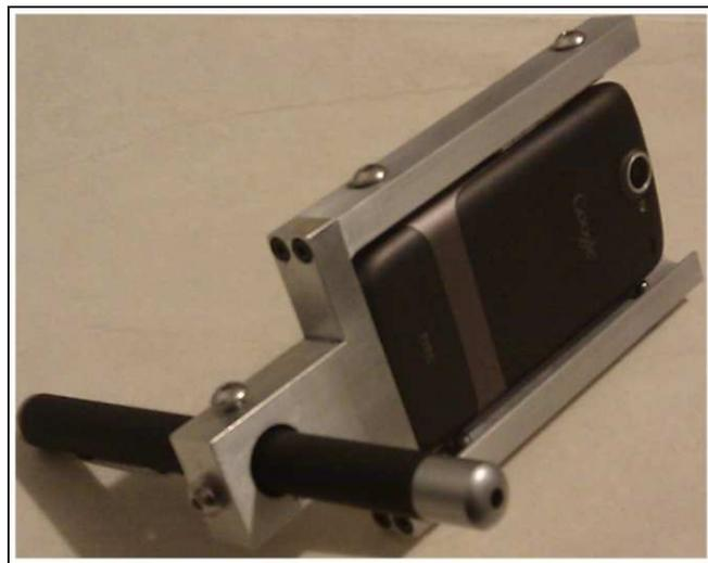
Figura 2. Virtual White Cane. Un láser es acoplado a un Smartphone por medio de una estructura, la distancia de los objetos es medida usando triangulación activa. La vibración del dispositivo indica la distancia del objeto apuntado (tomada con permiso de los autores [9])
